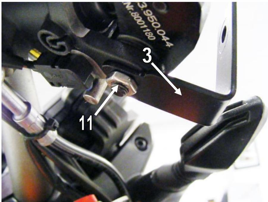
4. Setzen Sie die Gummiringe (5) und Stahlhülsen (6) in die Bohrungen der Handprotektoren ein. Befestigen Sie dann die Montageteile (4)+(10)+(15)+(16) zur Lenkerendbefestigung am linken Handprotector und (5)+(8)+(9)+(10)+(11)+(16) am rechten Handprotector und verschrauben Sie diese dann im Lenker.
