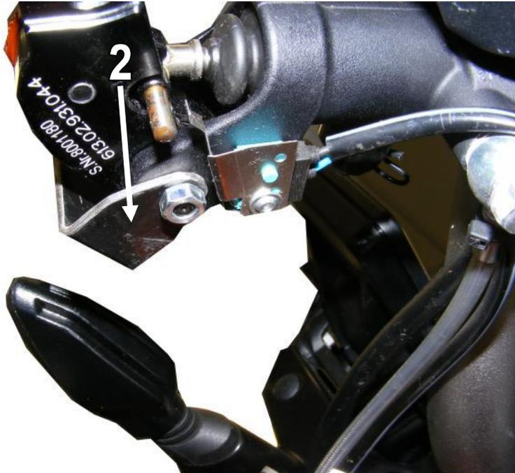
3. Demontieren Sie nun an der Unterseite des Bremshebels die Befestigungsmutter, legen Sie den Halter in Fahrtrichtung rechts (3) von unten an den Adapter an und befestigen Sie den Halter anhand der mitgelieferten Mutter (12).
