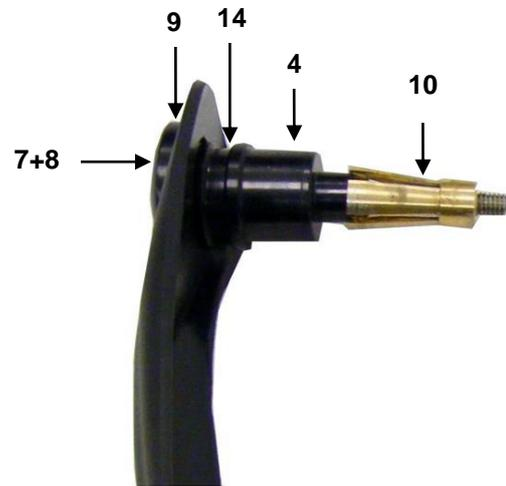
5. Richten Sie nun die Handprotektoren und die Halter zueinander aus und fixieren Sie die Handprotektoren mittels der Inbusschrauben M6x18mm (13) und Muttern (14) an den Haltern. Prüfen Sie nun die volle Funktionsfähigkeit der Brems- u. Kupplungshebel und ziehen Sie dann alle Schrauben fest an.
