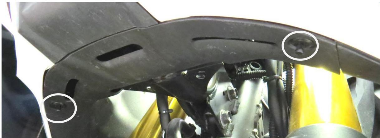
2. Setzen Sie die Gewindeklemmen über die Löcher der Kunststoffniete und montieren Sie die Abdeckung wieder.
