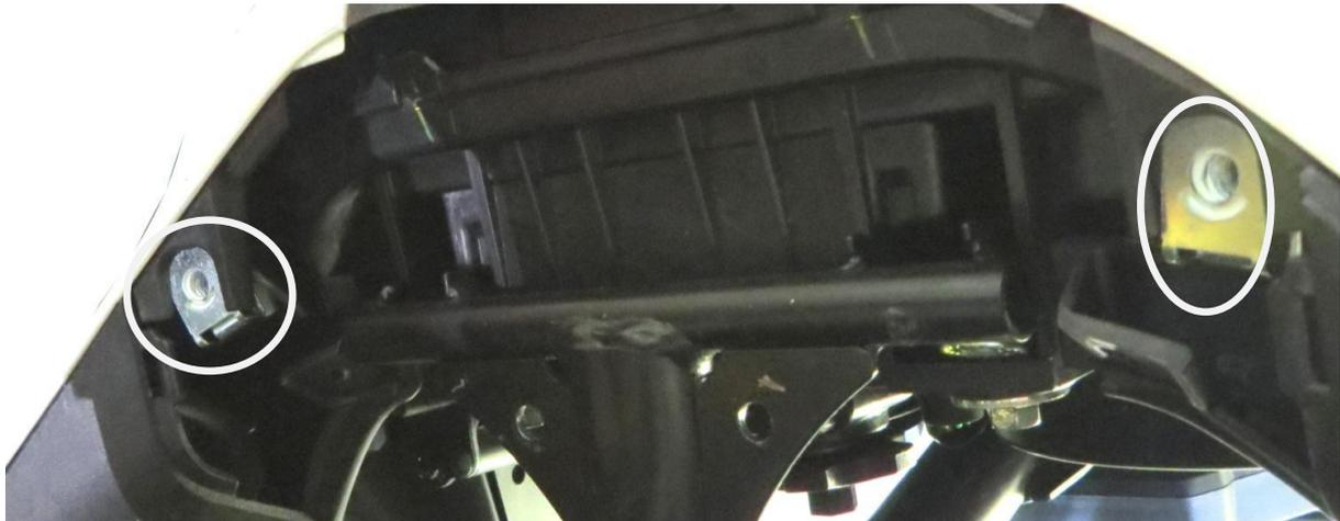
3. Ziehen Sie die Schutzfolie ab und setzen Sie die Gummieinsätze in die Bohrlöcher und dann die Metallhülsen in die Gummieinsätze ein.
