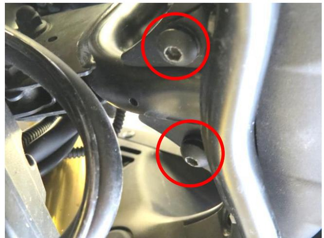
2. Entfernen Sie den schwarzen Teil des Sturzbügels vom Motorrad.
