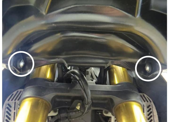
7. Befestigen Sie die Verlängerung mittels der M6x20 Schrauben, U-Scheiben und Muttern an der hinteren Rahmenaufnahme.
